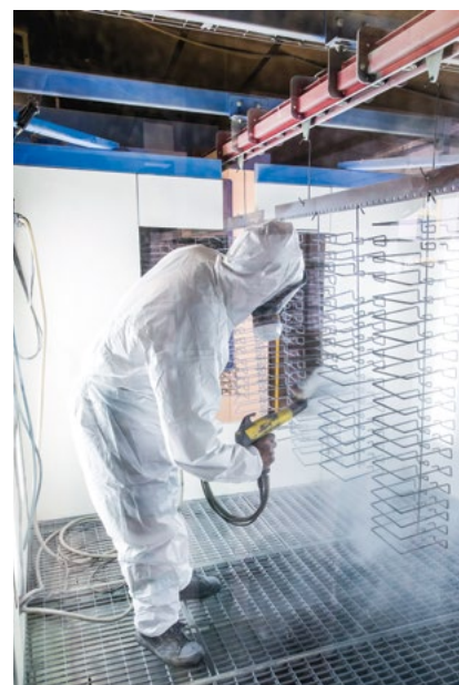
■ Figure 1. Application de peinture : le port d'équipement de protection individuelle (masque complet filtrant, gants et combinaison avec capuche) complète les mesures de prévention collective (cabine de peinture à ventilation verticale).
