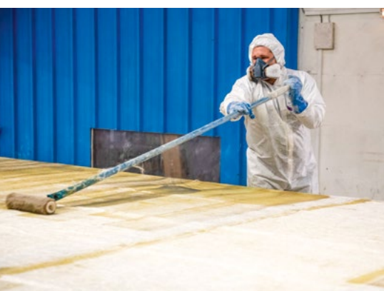
Figure 2. Fabrication de piscine : demi-masque filtrant, combinaison avec capuche et gants composent l'équipement de protection individuelle au poste de stratification.
