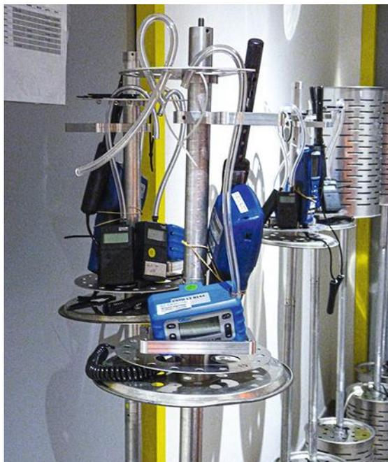
FIGURE 2 → Mise en œuvre des appareils permettant de caractériser la QAI.
